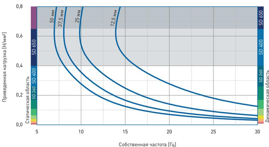
Собственная частота системы с одной степенью свободы, состоящей из постоянной массы и эластичного слоя PURASYS **vibrafoam** SD 400 на жесткой подоснове.
