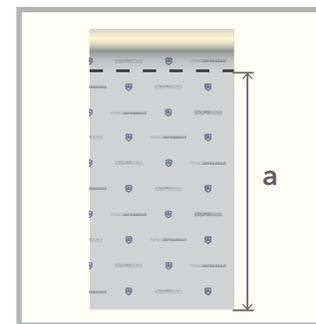
Наклеить по периметру ленту СтопЗвук V100 / Виброфлор. Ленту Виброфлор толщиной 4 мм сложить в два слоя, склеив их между собой, лента Виброфлор 6 мм монтируется в один слой. Для монтажа применяется виброакустический герметик Сонетик или клей Баутгер.
