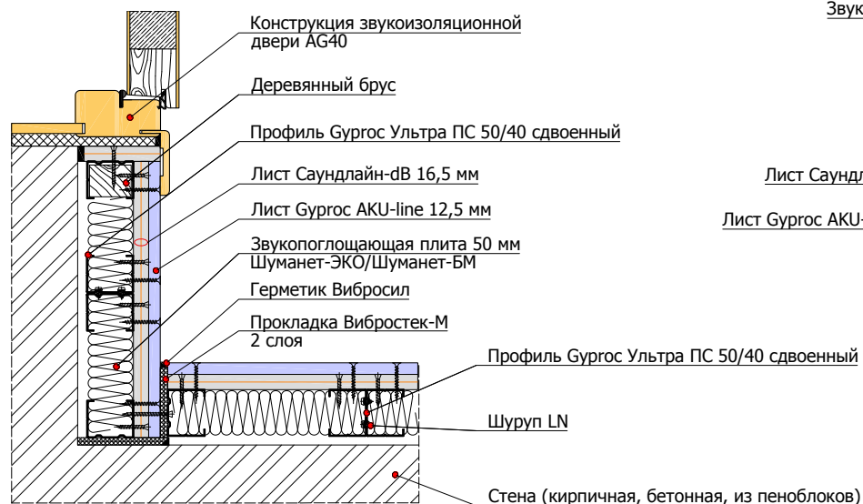
4.2.3 Монтаж облицовки стены на независимом сдвоенном каркасе 50 мм на внутренний угол и примыкание к дверному проему
