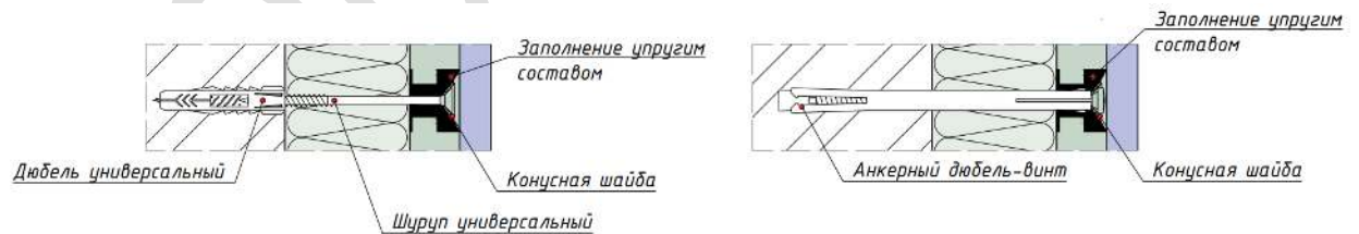
Рисунок 6. Схема закрепления панелей с применением универсального дюбеля и металлического анкера.
