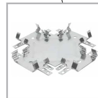
Крепим Виброподвесы Сонокреп с шагом 400 мм по горизонтали и 600 мм по вертикали
