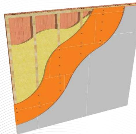
Закрепить обрешетку из деревянных брусков 30x50 с шагом 400 мм, через полосу виброизолирующей ленты Wolf Band 60. Головки саморезов утапливаются в брусок.
