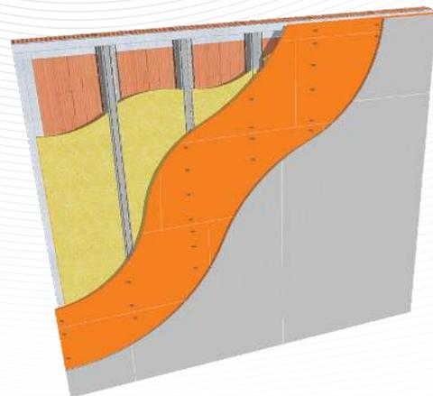
Металлический профиль и подвесы оклеить виброизолирующей лентой Wolf Band и закрепить профиль к стене саморезом шагом 400 мм, предварительно выставив по уровню.
