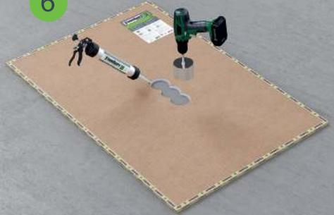
Отверстие под гнездо розетки или выключателя вырезается заранее в горизонтально расположенной панели SoundGuard ЭкоЗвукоИзол и промазывается виброакустическим герметиком SoundGuard Seal.
